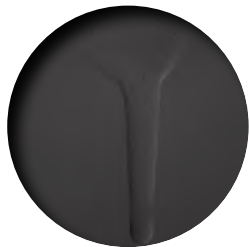
Descuelgue de pintura Paint runs / Glissement de peinture / Colatura di vernice
